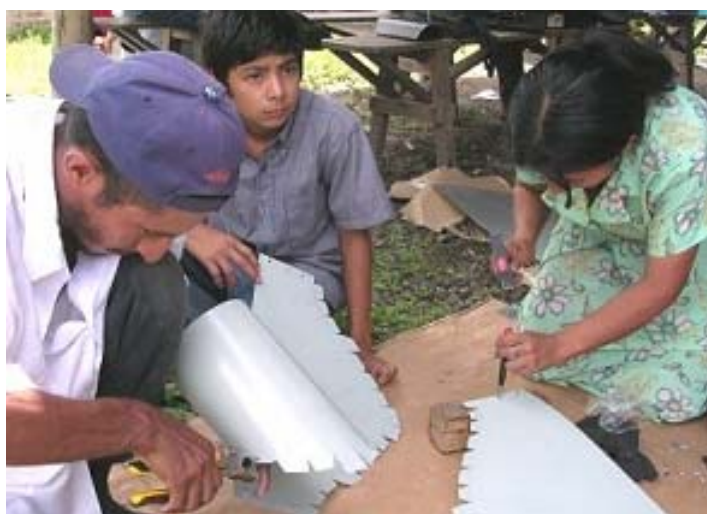
Cayetano Luna avec sa famille réussiront sans peine à construire, seuls, un coude de rechange
